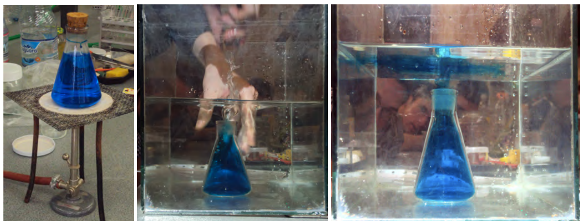
2.12. ábra. A felmelegedő levegő felszállásának modellezése (Makádi M. felvételei)
