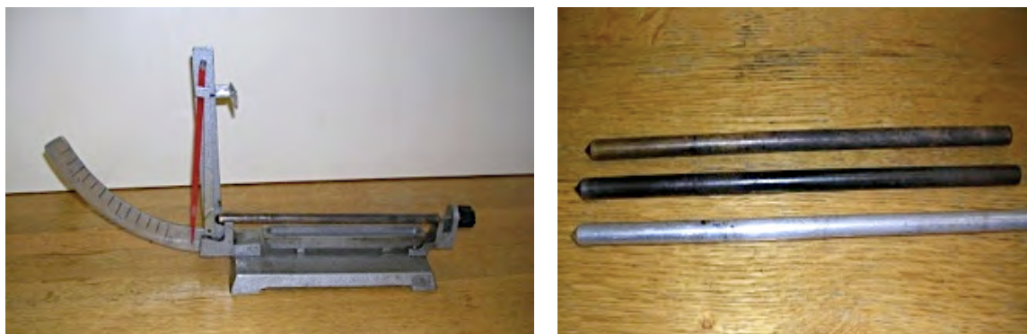
2.10. ábra. Emeltyűs pirométer (balra) és a három féle anyagból (vas, réz és alumínium) készült rúd (Radnóti K. felvétele)
